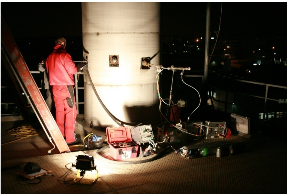
Bild 8: Ansicht der Messapparatur auf dem Dach des Asphaltmischwerkes während der Durchführung der Emissionsmessungen.
