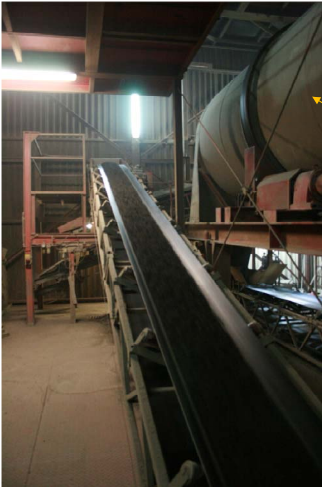
Bild 7: Blick in die Geschossebene des Mischwerkes, mit der darin befindlichen Paralleltrommel. Im Vordergrund ist das Förderband für die Zugabe des Asphaltgranulats erkennbar.
