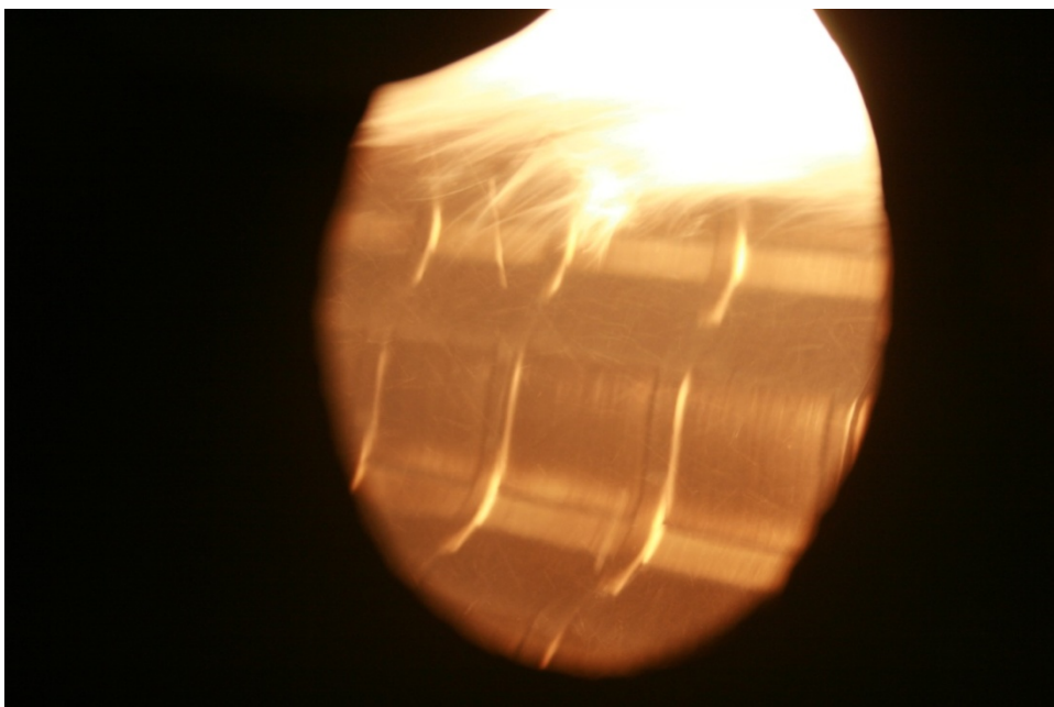
Bild 6: Blick in die rotierende Paralleltrommel während der Befuerung. Das Asphaltgranulat wird hierbei auf Temperaturen von 110 – 140 °C aufgeheizt. Es ist erkennbar, wie der Bereich des Flammeneinlasses mit Edelstahlblechen ausgekleidet ist. Es wird kein Asphaltgranulat direkt der Flammeneinwirkung (hier ölbefeuerte Flamme) ausgesetzt. Die Bleche sind frei, man erkennt sie metallisch glänzend, d.h. frei von Asphaltgranulat.
